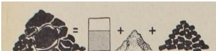
Слика 18. Једна тона ровног угља = вода + пепео + чисти угаљ
